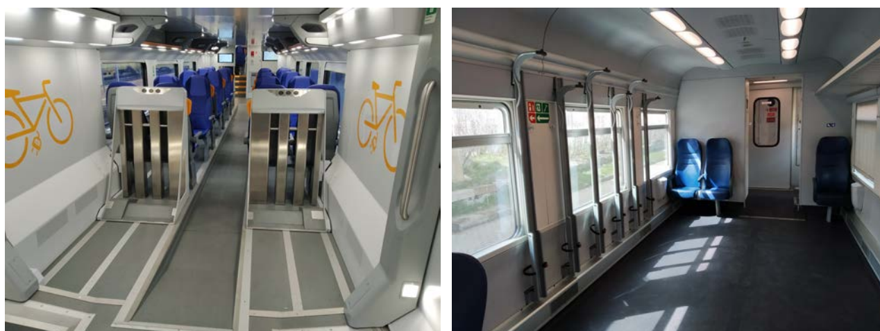
Aménagements pour les vélos dans les rames italiennes utilisées sur la ligne Torino - Bardonecchia
